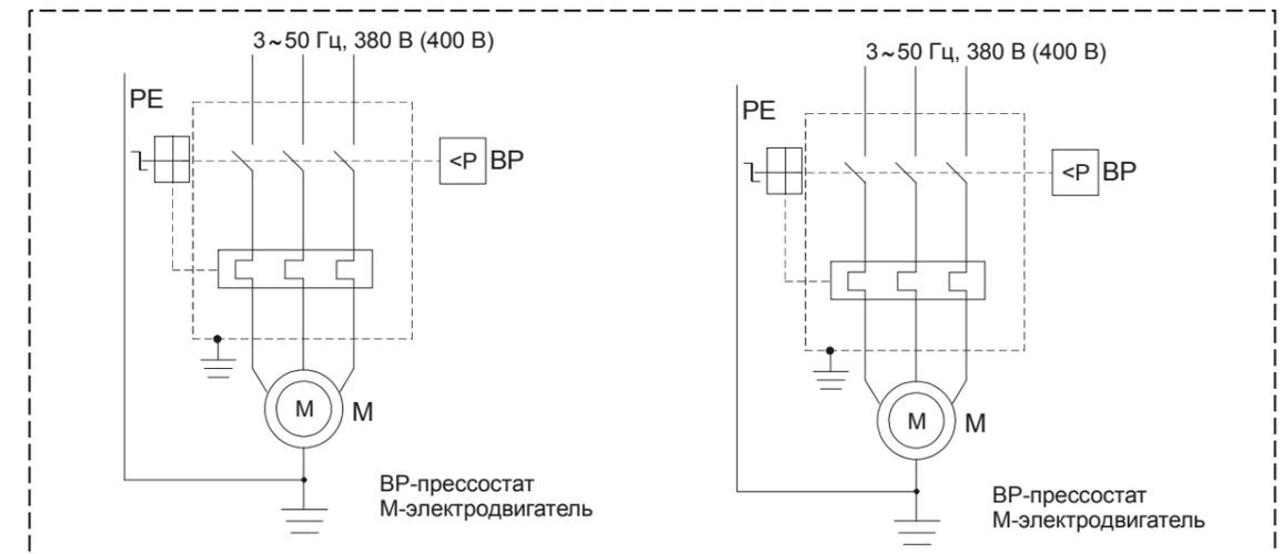
Рисунок А.2 – Схема электрическая принципиальная компрессора СБ4/Ф-500.АВ858ТБ
