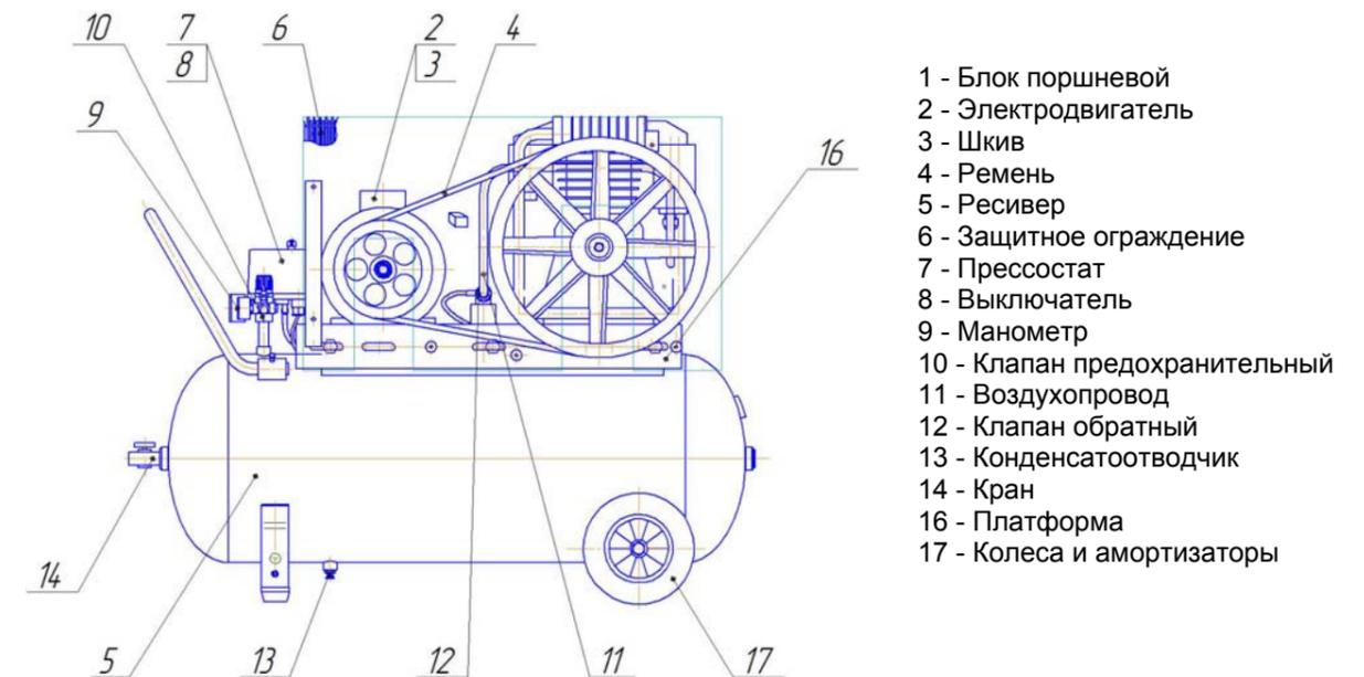
Рисунок 5 - Общий вид компрессора СБ4/С-100.АВ858
