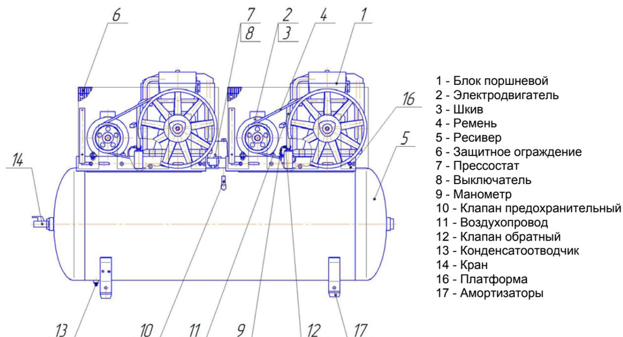
Рисунок 11 - Общий вид компрессора СБ4/Ф-500.AB858ТБ
