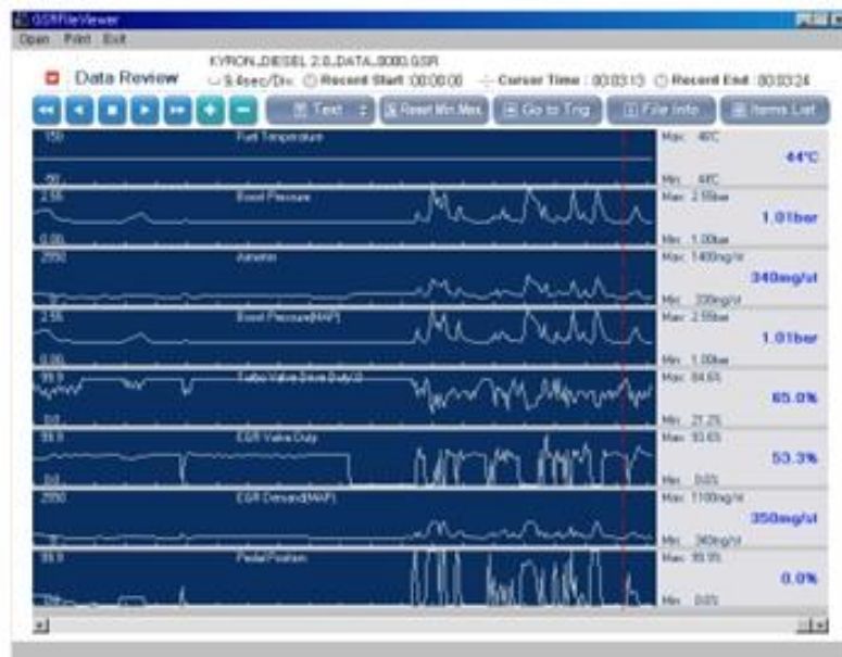
[Рис. 14] Курсор А передвинут к отмеченному триггером месту В текстовом режиме на дисплей выводятся параметры, в месте, отмеченном триггером.
