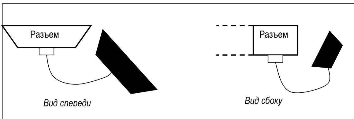
небольшой шарнирный кожух из твердого пластика, закрывающий разъем OBDII:
