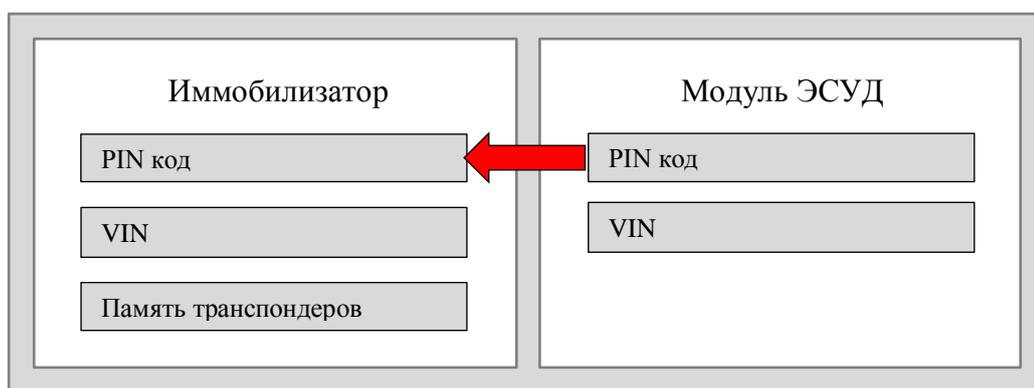
По завершении процедуры иммобилизатор и модуль ЭСУД “привязаны” и готовы к совместной работе.
