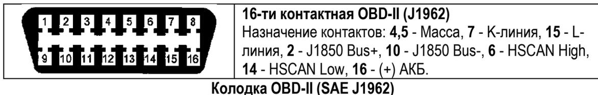
**ПРИМЕЧАНИЕ.** В диагностической колодке могут присутствовать только контакты, используемые для выбранного производителем автомобиля протокола. Например, для протокола CAN используются только контакты 4, 5, 6, 14, 16.
