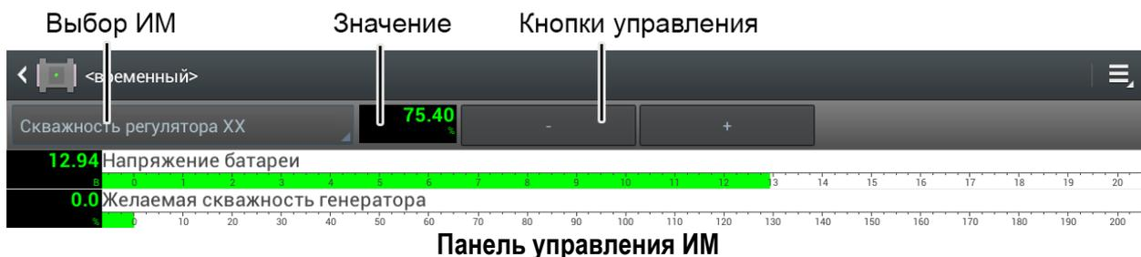
Выберите исполнительный механизм из раскрывающегося списка на панели управления. В правой части панели отобразятся кнопки управления. При помощи кнопок на панели механизм переводится в одно из возможных положений (ВКЛ / ВЫКЛ, ОТКРЫТЬ / ЗАКРЫТЬ и др.) или его значение плавно изменяется (кнопки “-” / “+”).
