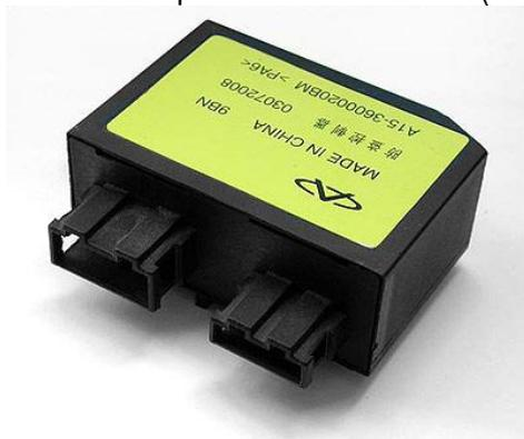
**A15-3600020BM** – не имеет внешнего EEPROM, тип транспондеров: PCF7935AS. Допускает привязку чистых транспондеров и повторную привязку уже использованных.
