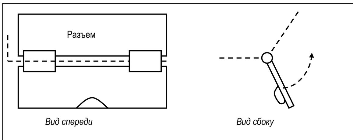
большой кожух из твердого пластика, под цвет отделки салона автомобиля, закрывающий разъем OBDII и колодку предохранителей:
