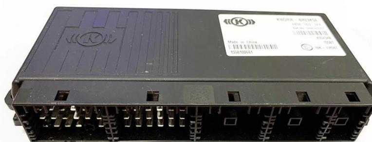
17-ти контактный разъём X1 (левый): 1 – земля, 16 – питание, 8 – CAN1\_H, 7 – CAN1\_L
