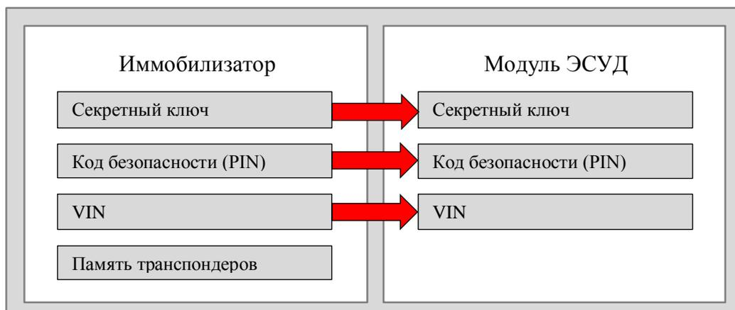
По завершении процедуры иммобилизатор и модуль ЭСУД “привязаны” и готовы к совместной работе.
