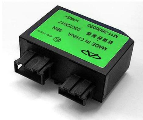
**M11-36000020** – имеет внешний EEPROM типа Microchip 24LC08B. Тип транспондеров: PCF7936AS. Транспондеры должны быть специальным образом запрограммированы на заводе Chery - привязка чистых транспондеров не допускается. Поэтому их следует заказывать только у поставщиков запчастей Chery для конкретной модели автомобиля. Допускается повторная привязка уже использованных транспондеров
