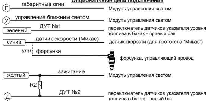
Для корректной работы с двумя топливными баками необходимо установить дополнительно резистор R2.
