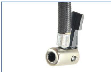
Выберите подходящий адаптер и плотно вставьте резьбовой конец в разъем воздушного шланга, затем зафиксируйте его на месте, повернув фиксирующий рычаг разъема на 90 градусов.
