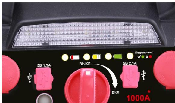
1. Нажмите и удерживайте в течение 3 секунд кнопку **«Тест/USB/Фонарь»**, а затем отпустите, после чего включится LED-фонарь и активируется USB-порт. Если емкость батареи менее 10 вольт, освещение и USB-порт автоматически выключатся.
